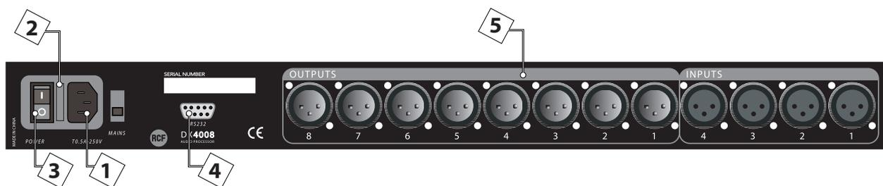
**1. Alimentazione** – Presa di corrente standard IEC. Con l'apparecchio viene fornito un cavo d'alimentazione. La tensione d'ingresso è 115VAC o 230VAC ed è chiaramente indicata sull'apparecchio. Il tipo di tensione deve essere specificato all'atto dell'ordine.
